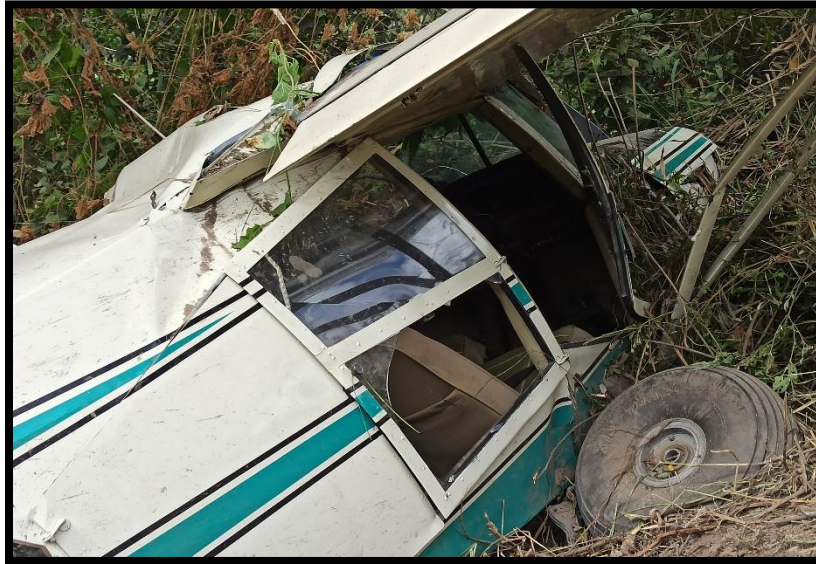
Fotografía No. 3 Vista del tren de aterrizaje derecho, enterrado en el área del impacto.
