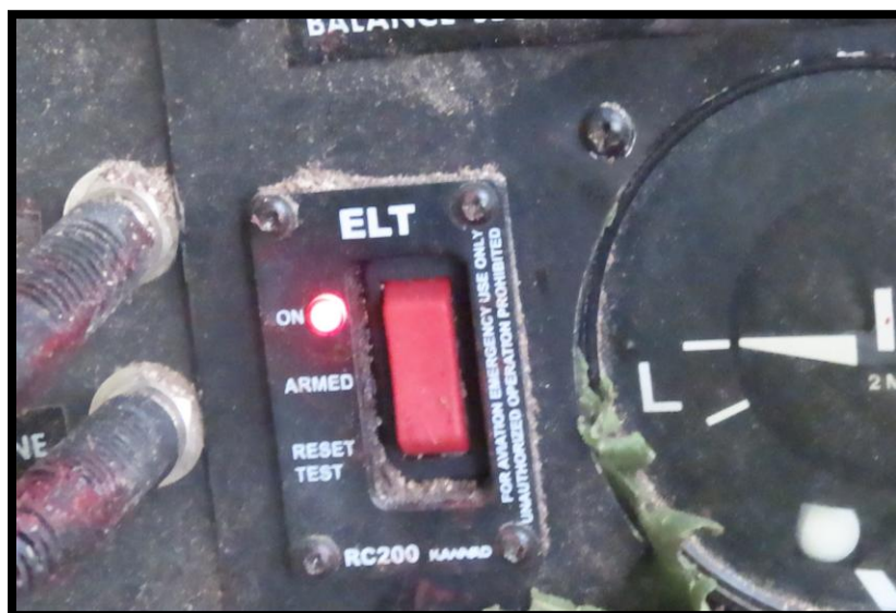
Fotografía No. 5 Vista del ELT activado.
